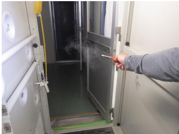
スモークテスターでの気流の確認
